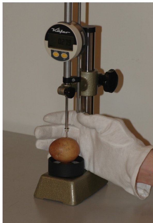
Messung der Eierschalen-Dicke mit einem speziell angefertigten Messinstrument im Labor des NABU-Vogelschutzzentrums Mössingen.
